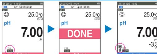
5. Répétez les étapes 1 à 4 pour effectuer l'étalonnage avec le ou les tampons de pH suivant(s).
